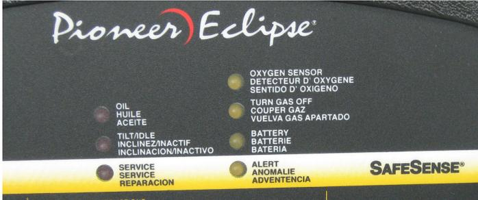
**HINWEIS:** Nach dem Starten des Motors blinkt das GELBE Warnlicht während des 3-Minuten-Aufwärmzyklus des SafeSense-Systems (Die Maschine kann während dieser Aufwärmphase benutzt werden). Nach dem Aufwärmzyklus erlischt das Warnlicht. Solange die Maschine sicher läuft, leuchtet keines der SafeSense-Lichter.
