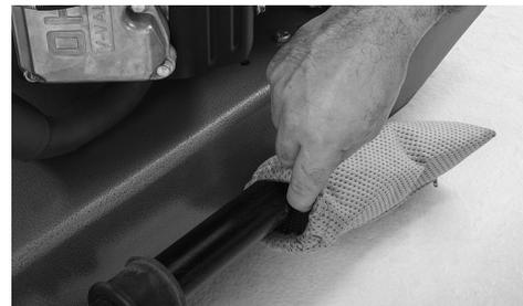
zeigenden Bewegung, um Verunreinigungen zu lösen, die sich möglicherweise an den Seiten des Beutels festgesetzt haben. Drehen Sie den Beutel bei starker Verschmutzung nach außen, um ihn zu reinigen.
