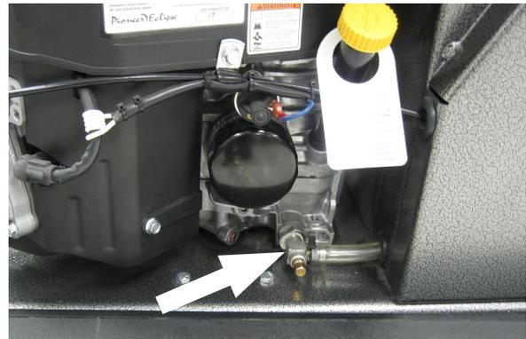
9. Entfernen Sie den Öleinfüllverschluss und füllen Sie frisches Sentinel Öl ein. Füllen Sie 1,5 l ein, wenn der Filter nicht gewechselt wurde, 1,7 l nach einem Filterwechsel.
