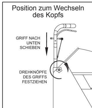
8. Heben Sie an der Vorderseite des Decks an, indem Sie die Maschine nach hinten rütteln, bis sie auf den Handgriffen liegt.
