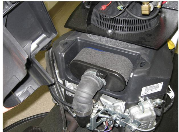
**VORSICHT!** Waschen Sie keine Luftfilter. Ölen Sie keine Luftfilter. Benutzen Sie keine Druckluft zum Reinigen der Luftfilter.
