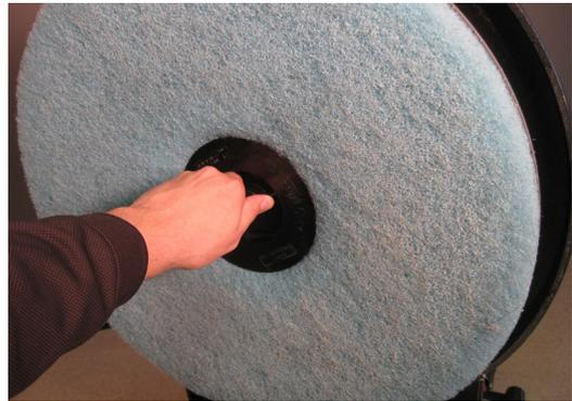
**VORSICHT!** Überprüfen Sie die Padhalterung sorgfältig auf Risse oder Schäden. Tauschen Sie sie bei Bedarf aus.
