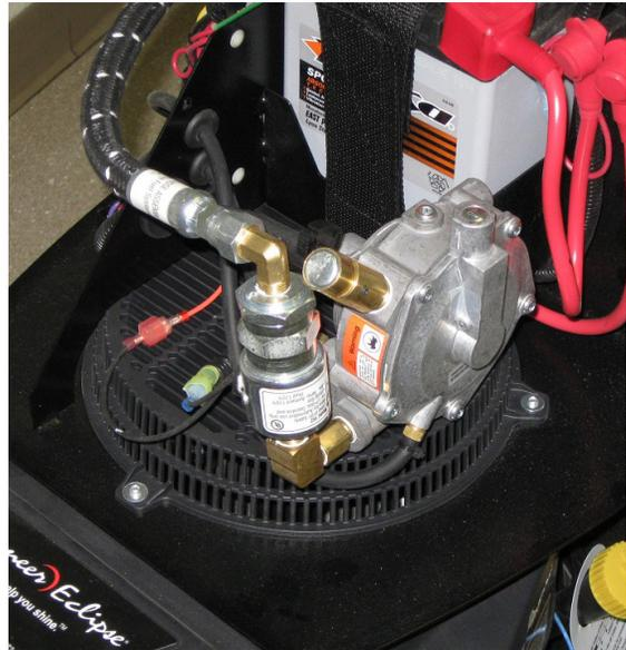
Seifenwasserlösung auf alle Anschlüsse geben, während die LP-Flasche angeschlossen und das Service-Ventil eingeschaltet ist (ON).
