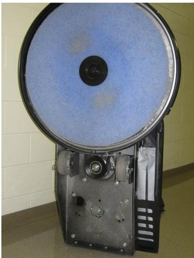
5. Entfernen Sie die Zentriervorrichtung und überprüfen Sie das Pad. Ist das Pad auf eine Dicke von weniger als 6 mm abgenutzt, ersetzen Sie es.
