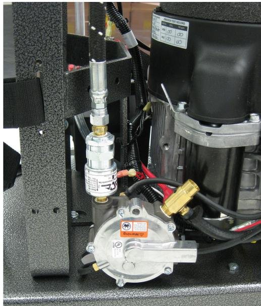
5. Si se detecta una fuga, apague el cilindro de LP. Si la fuga está en una manguera, reemplácela. Si la fuga está en una conexión, desconéctela y límpiela. Aplique compuesto sellador de tuberías y vuelva a colocarla.
