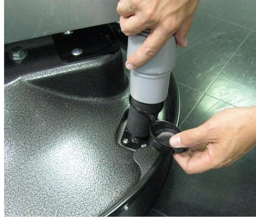
3. Para una manguera de vacío de 2" de diámetro, se debe dejar el adaptador de la manguera negra en el tubo de recolección de polvo y la manguera se debe presionar hacia abajo, sobre el tubo, hasta que haga tope. Se puede necesitar una abrazadera si la manguera no encaja bien.
