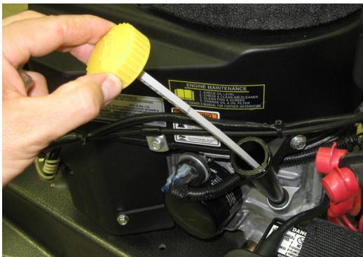
5. La máquina debe estar en posición vertical y nivelada. Si es necesario, coloque un bloque debajo de la parte posterior de la máquina o aplique peso en el frente de la plataforma para mantenerla en posición vertical y nivelada.
