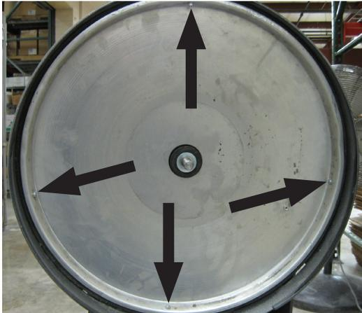
3. Usando una llave de 3/8”, retire la tuerca que sujeta el accesorio de la solución en el revestimiento.
