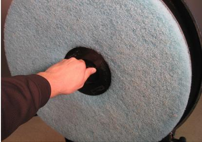
**¡PRECAUCIÓN!** Inspeccione detenidamente el soporte de la almohadilla para verificar que no presente grietas o daños. Reemplácelo, si es necesario.
