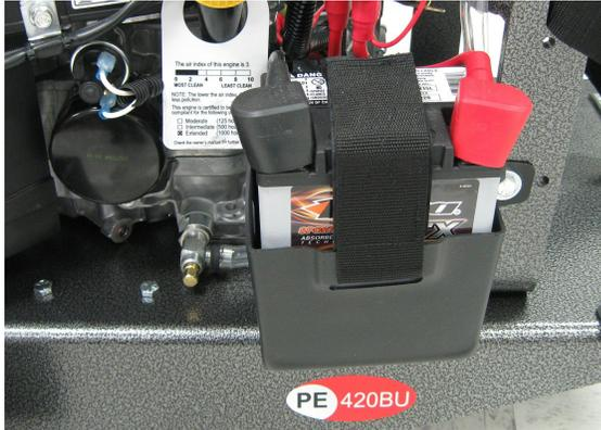
3. Primero, desconecte el cable negativo NEGRO de la batería. Luego, desconecte el cable positivo ROJO de la batería.
