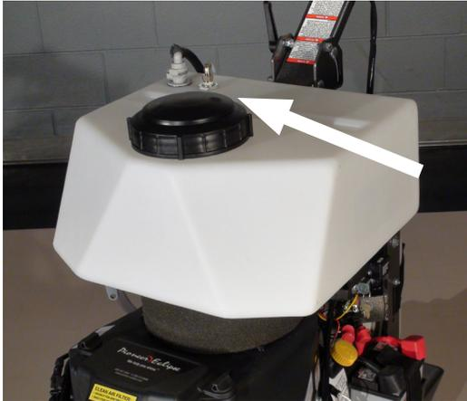
3. Retire la tapa del depósito de solución.
