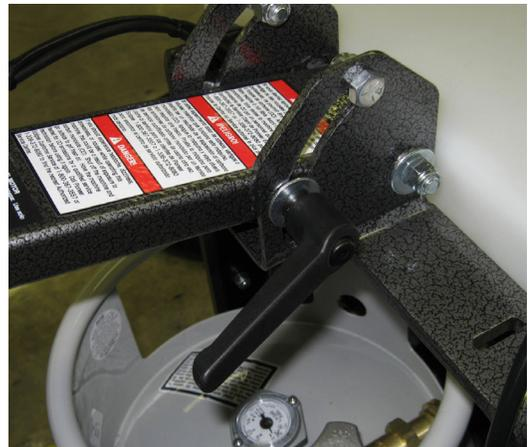
**NOTA:** La palanca de ajuste del mango es graduable. Tire hacia afuera y gire la palanca a la dirección deseada.
