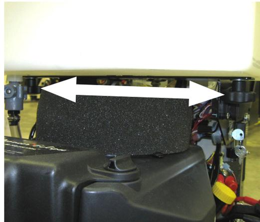
4. Desenganche el extremo abierto de la manguera de drenaje del depósito de solución y retire ese último.
