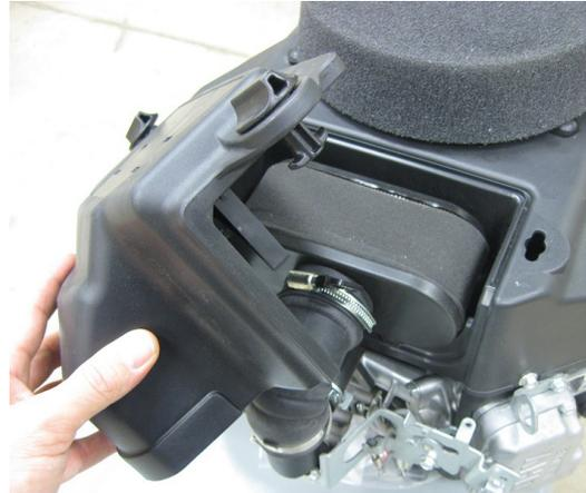
**¡PRECAUCIÓN!** No lave los filtros del limpiador de aire. No engrase los filtros de aire. No utilice aire a presión para limpiar los filtros de aire.
