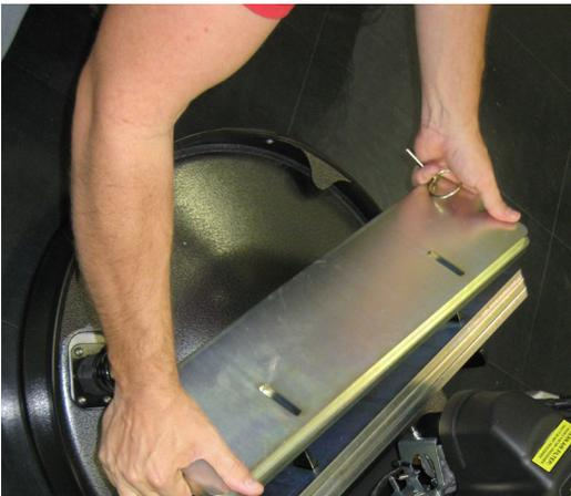
4. Añada los pesos al colocar las dos ranuras sobre las lengüetas del soporte de peso. **NO** instale los pesos al revés.
